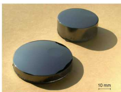
Рисунок 1 - Объемные кристаллы-були карбида кремния и вырезанная из були пластина, отполированная с двух сторон
