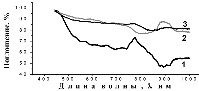
Рис.1. Спектры поглощения \text{Bi}_{12}\text{GeO}_{20} 1-необлученный; 2-облученный; 3-после отжига.
