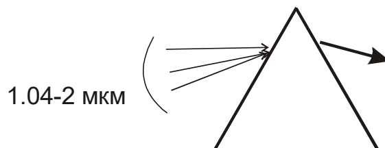
Рис.1. Спектральное уплотнение с использованием диспергирующего элемента
