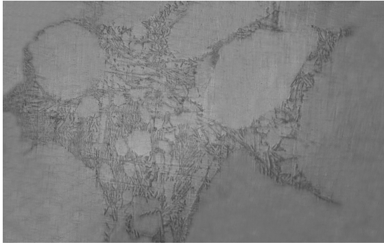
Рис. Вид включений Al-Si после электроотжига поликристаллов алюминия при температуре 620^{\circ}\text{C} , j=1,6 \cdot 10^6 \text{ A/m}^2 (направление миграции слева направо).
