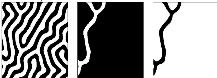
Рис. 1. Фотографии доменной структуры после бинаризации и при последующем анализе изображения
