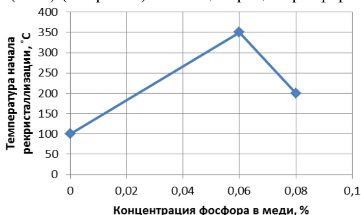
Рис. 1. Зависимость ТНР от концентрации фосфора в меди после 1 цикла РКУП (указана концентрация в атомных процентах)
