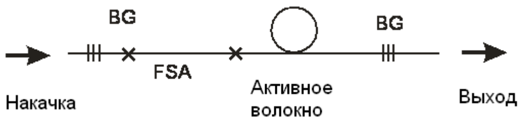
Рис.1. Общая схема лазера с волоконным насыщающимся поглотителем.
