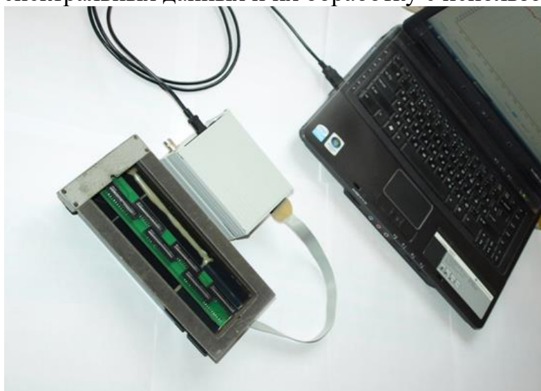
Рис.4. Система многоканальной цифровой регистрации спектров.
