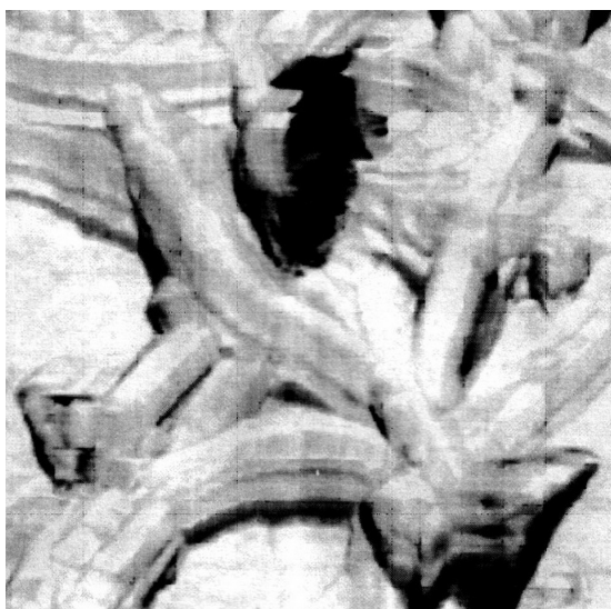
Рис. 3. Микрофотография МУНТ диаметром 40-60 нм (фазовый контраст). Атомно-силовой микроскоп Solver P47-Pro.
